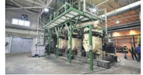
Вельский ЛПК внедряет новое оборудование для пеллетного производства. С этой целью в цех были закуплены и установлены три усовершенствованные матрицы для пресс-грануляторов — по одной на каждую производственную линию. Главная их особенность заключается в длине каналов, через которые выпрессовывается древесное сырье. Вместо 55 миллиметров она теперь составляет 40 мм. Благодаря этому материал через них проходит быстрее, а механическая нагрузка на оборудование снижается в разы.
